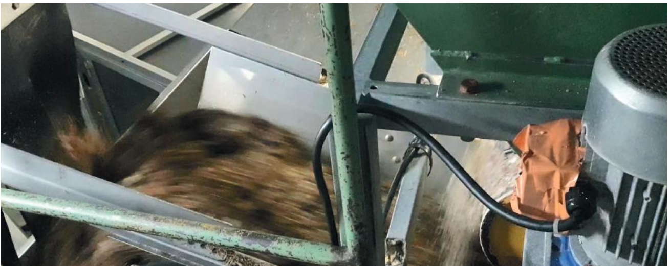
Photos : le tapis mélangeur de « ChampiCreuse ». Le substrat pasteurisé dans le four est déplacé sur le tapis. En haut du tapis, le substrat est égalisé en une couche mince qui reçoit automatiquement le « blanc » développé sur graines de céréales.
